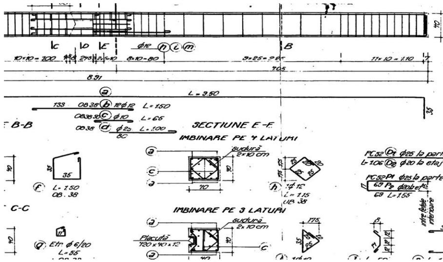
Fig. 2.22 RC precast column
