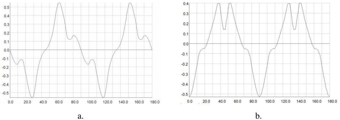
**Fig. 2.7.** Flux density distribution:  $a$   $d$ -axis,  $b$   $q$ -axis.
