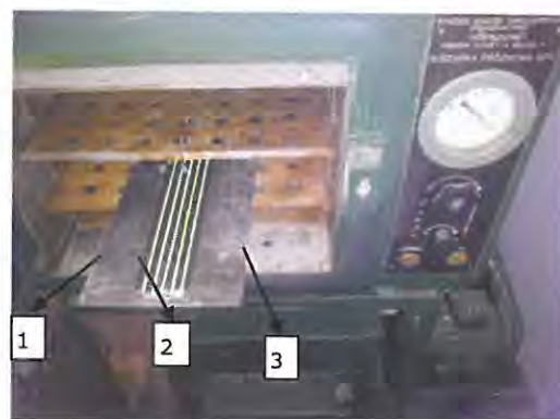
Figura 2.2. Vergele învelite de analizat. 1-vergea învelită; 2-element separator din material ceramic grafitat; 3-cuptor cu incintă vidată.
