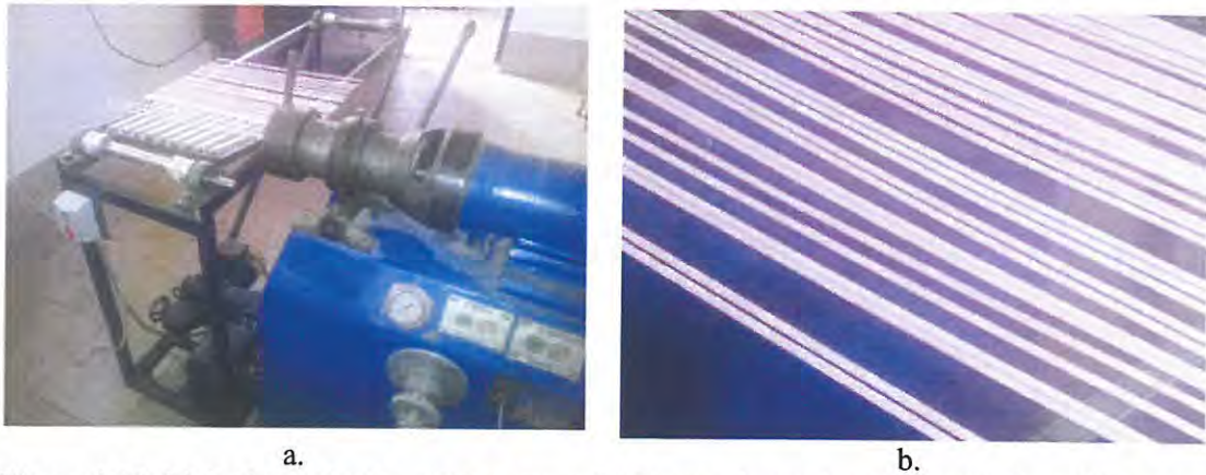
Figura 4.13. Linie de producție, a) linia cu multiplicator de presiune și bandă de preluare cu o singură cale, b) vergele de brazare.
