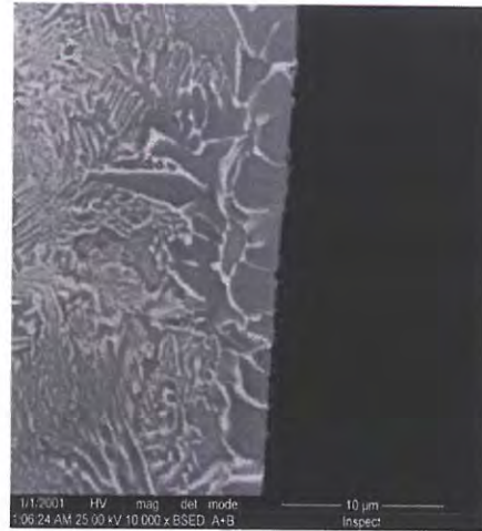
Figura 5.27. Zona de trecere între materialul de brazare (aliaj AgCuZnSn) și materialul de bază (oțel inoxidabil 18.8) 10000X.
