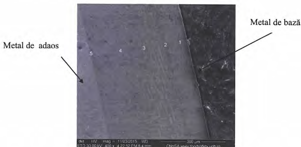
Figura 5.34. Punctele de determinare a compoziției chimice locale, Zona A (400x). 1) MB; 2-4) ZIT; 5) interfața cu materialul de adaos topit.
