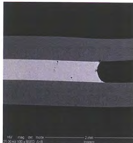
Figura 5.29 Imagine macroscopică a îmbinării brazate prin suprapunere. Zona de ieșire a materialului de adaos 100X.
