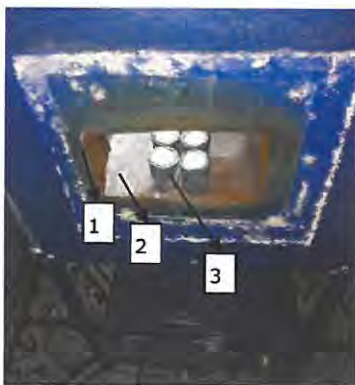
Figura 2.1. Epruvete de analizat. 1-masă omogenizată; 2-incintă calibrată din grafit; 3-cuptor cu protecție de argon.
