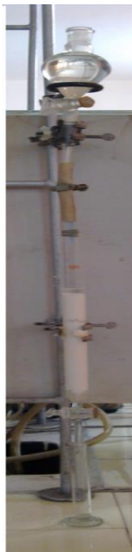
Figura 3. Schema de obținere a materialelor prin impregnare, utilizând metoda de impregnare în regim dinamic, pe coloană
