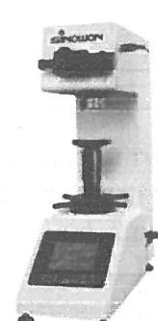
Fig.2.6. Microdurimetru digital Vikers HV-50AC
