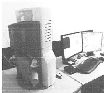
Fig.2.3. Microscopul electronic cu baleiaj TESCAN VEGA 3 LMU Bruker EDX Quantax
