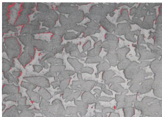
Figura 10. Micrografie procesată ce redă porozitatea stratului WC-Co-NiP
