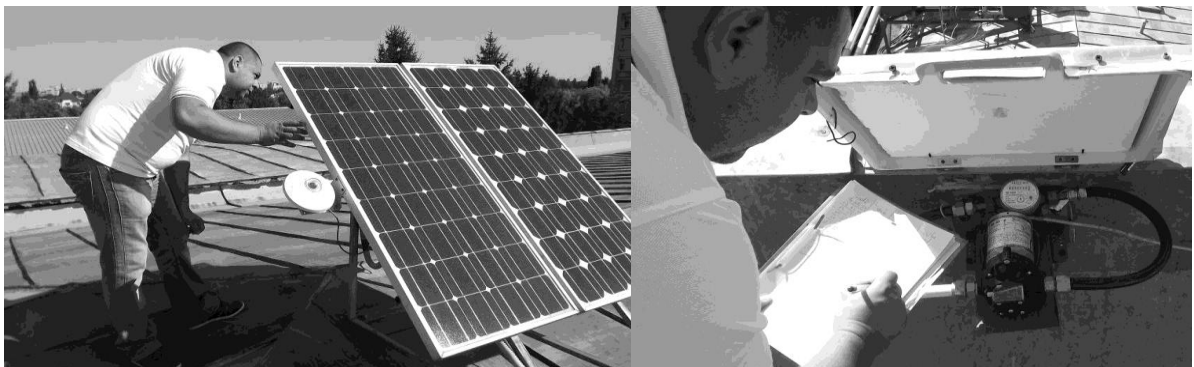
Figura 5.3. Schema montajului experimental pentru studierea sistemului fotovoltaic de pompare a apei cuplat direct: G - este un piranometru pentru măsurarea iradianței solare pe suprafața modulului PV; T - este un senzor termic pentru măsurarea temperaturii ambientale; D - este un debitmetru standard.
