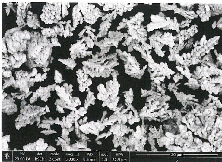
Fig.5. Vizualizarea particulei de argint prin analiză SEM (ordin de mărire x5000)
