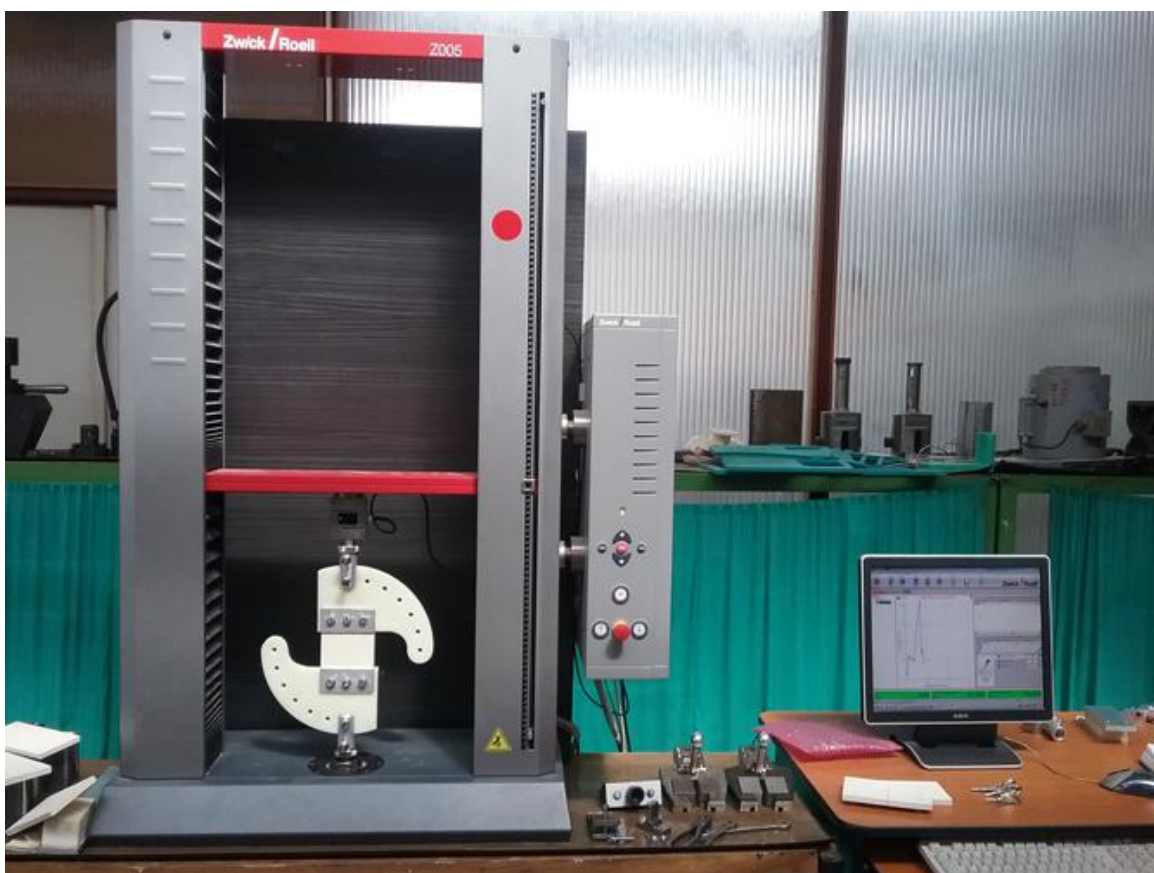
Figura 5.10 Imaginea de ansamblu a mașinii universale pentru încercări de tracțiune-compresiune Zwick Roell 005 de 5 kN
