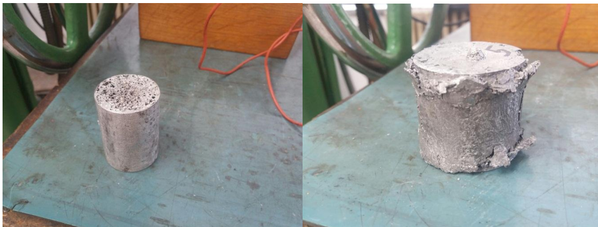
Fig. 4.4. Epruvetele utilizate în cadrul încercărilor experimentale de compresiune
