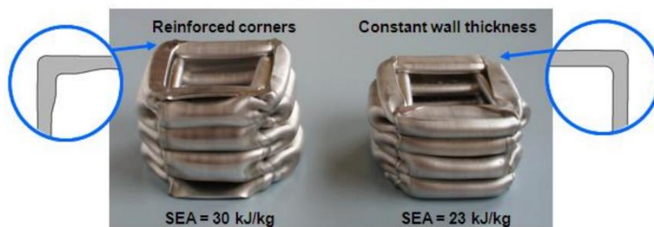
Figura 2.2 Colțurile armate măresc capacitatea specifică de absorbție a energiei a extrudărilor de aluminiu
