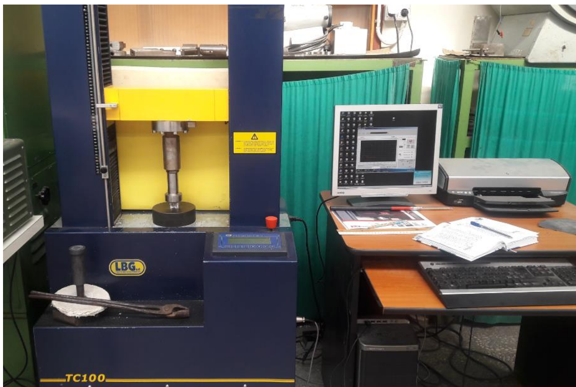
Figura 3.5. Mașina universală de testare TC100; capacitate 100 kN
