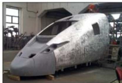
Figura 1.8 Aplicații ale spumelor metalice
