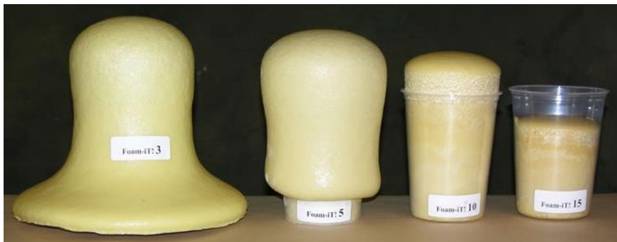
Figura 1.5 Procesul de formare a spumei poliuretane
