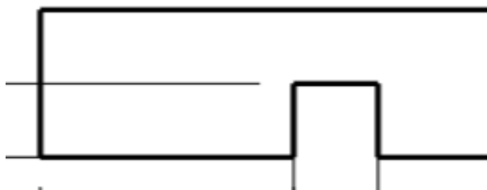
Figura 3.14 Canal realizat prin operația de frezare
