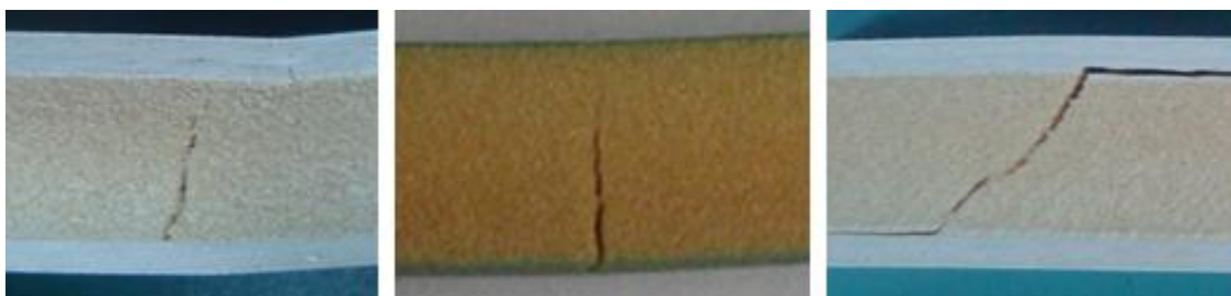
Figura 5.3 Forfecarea miezului din spumă pentru un material de tip sandwich
