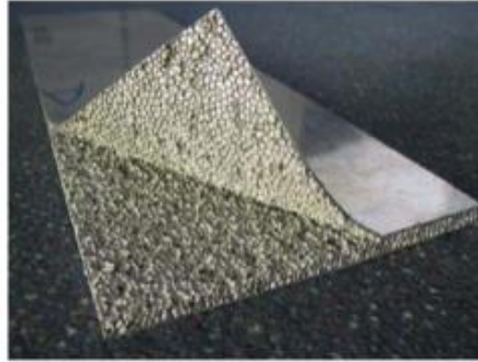
Figura 1.5 Aplicații ale spumelor metalice în industria automotive
