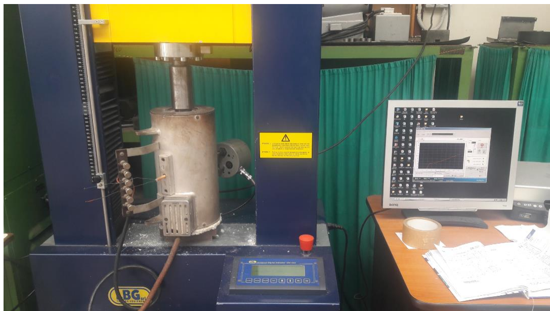
Figura 3.6. Incinta termica instalata pe masina de testare
