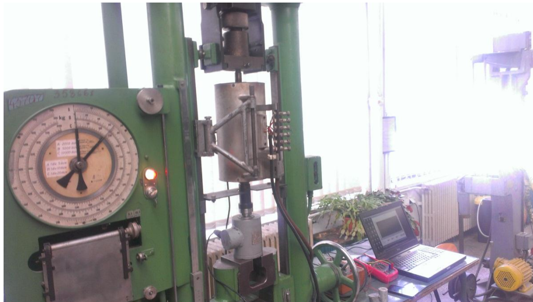
Fig. 4.2. Imagine de ansamblu a mașinii de încercat universală de 10 kN
