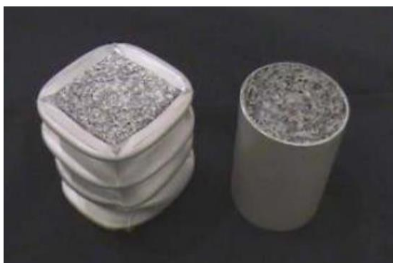
Figura 2.1 Profile extrudate umplute cu spumă de aluminiu pentru cutiile de impact
