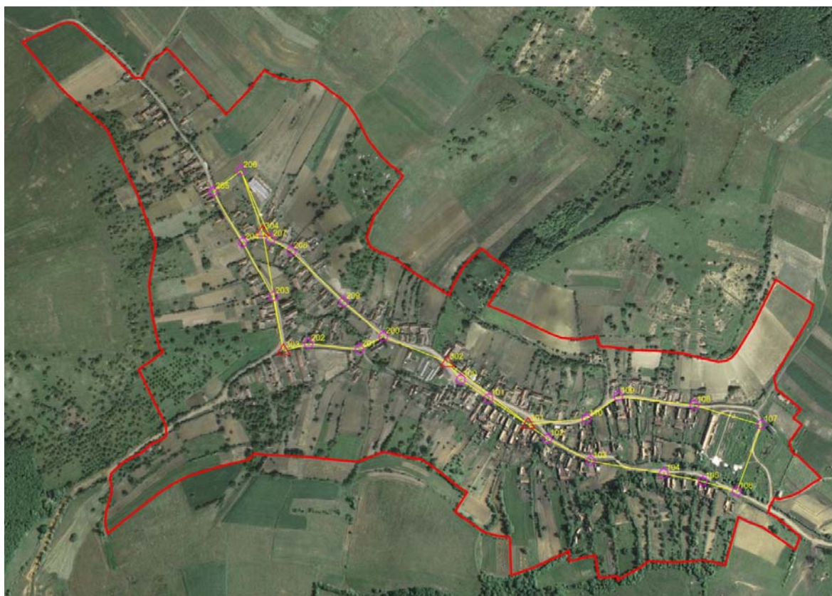
Fig. 12 Schița drumuirii – rețea de îndesire și ridicare
