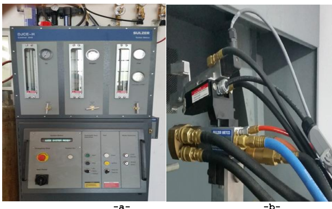
Fig.4.3 Echipamentul de pulverizare HVOF: a – modulul de comandă; b- pistolul DJM 2700
