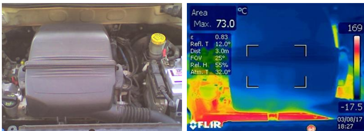
Figura 11. Câmpul termic pe carcasa filtrului de aer
