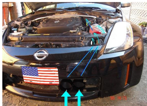
Figura 9. Implementare SDTA - circulația aerului
