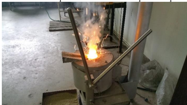
Fig.10 Adăugarea peletelor pe baia de oțel lichid
