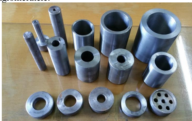
Fig.5 Matrițe utilizate pentru realizarea brichetelor
