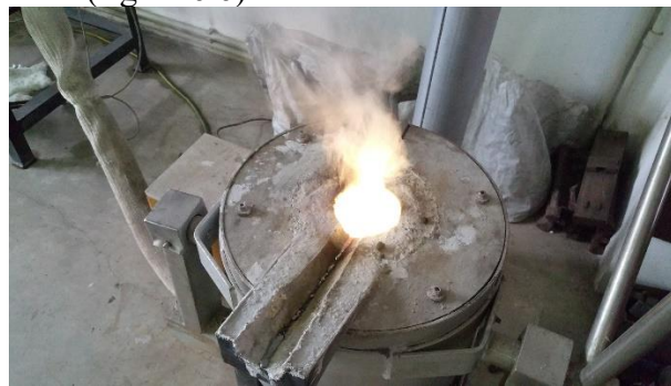
Fig.11 Gazele evacuate în urma reacției de reducere a zincului
