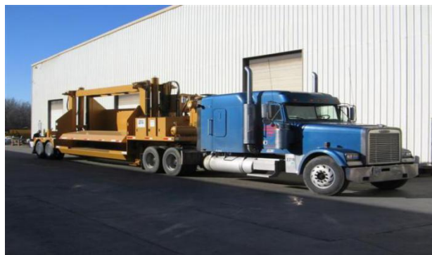
Figura 3.13. Macara mobilă pentru reciclarea automobilelor care se deplasează la locația beneficiarului
