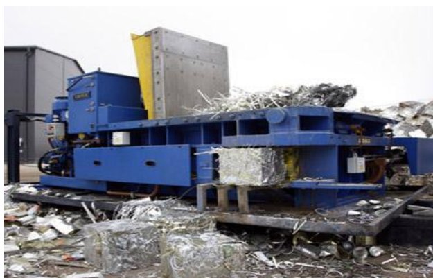
Figura 3.8. Presa de balotat fier vechi ușor
