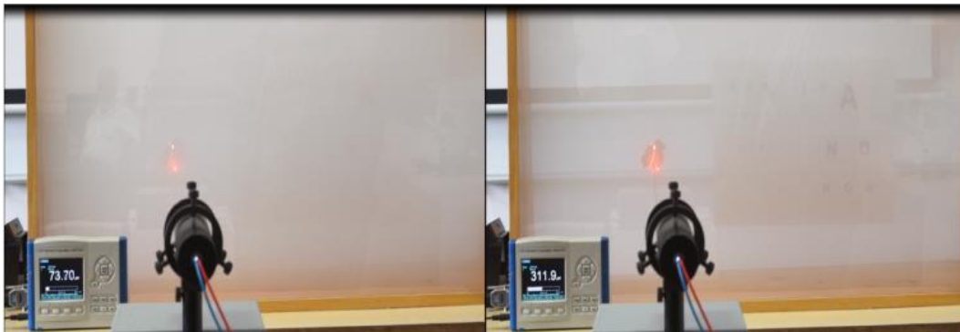
Fig. 5. Configurația cu strat de ceață: a) Condiții cu ceață densă; b) Condiții cu ceață moderată
