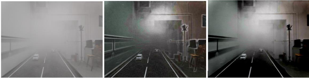
Fig. 9 Imaginea cu ceață densă: a) originală; b) ceață eliminată; c) rafinată aplicând DCP
