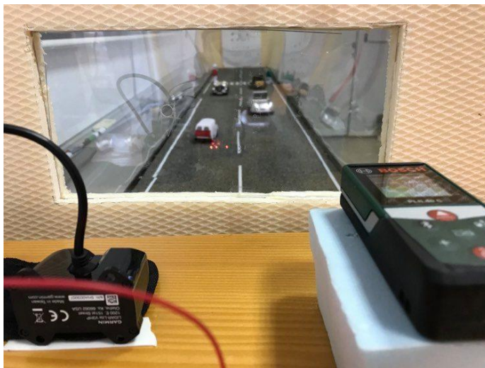
Fig. 7. Evaluarea rezultatelor lidarului și telemetrului în diferite condiții de ceață
