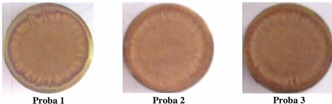
Fig.4.48 Imagini macroscopice (înregistrări aparat Canon A 480) ale suprafețelor erodate prin cavitație vibratoare, timp de 165
