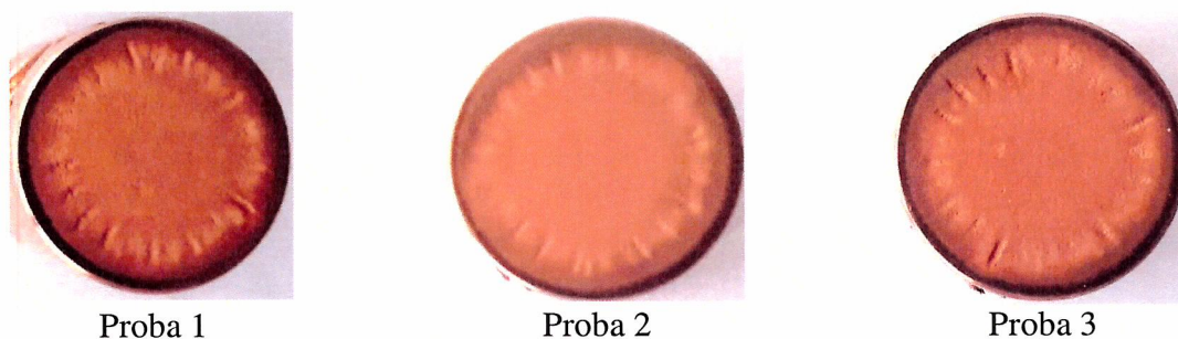
Fig.4.33 Imagini macroscopice (înregistrări aparat Canon A480) ale suprafețelor erodate prin cavitație vibratoare, timp de 165 minute
