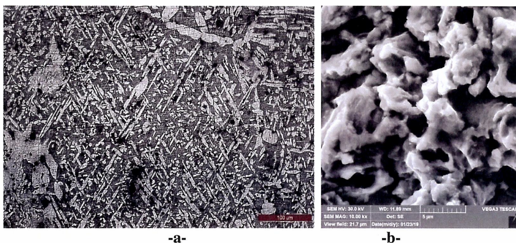
Fig.4.37 Imagine microscopică (a) și imagini SEM (b), după 165 minute de expunere la cavitație
