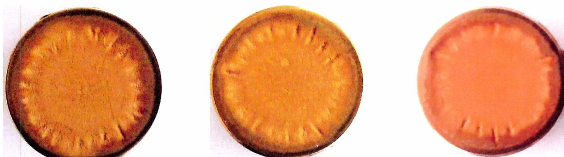
Fig.4.15 Imagini macroscopice (înregistrări aparat Canon A480) ale suprafețelor erodate prin cavitație vibratoare, timp de 165
