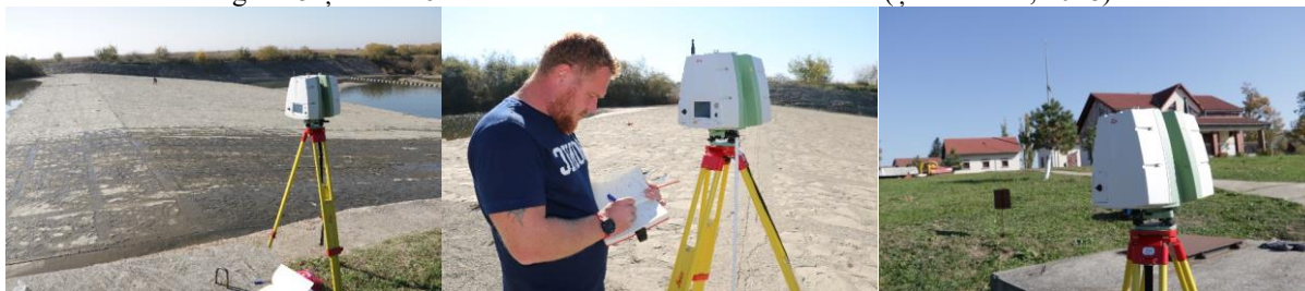
Fig. 4.22 Scanarea 3D a obiectivului - NH Coșteiu (Șmuleac A., 2018)
