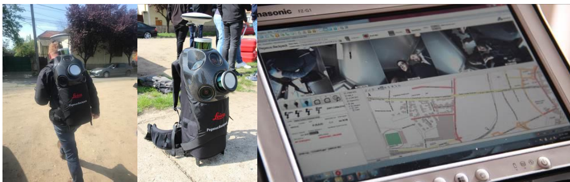
Fig. 2.24 Prezentarea echipamentului Leica Pegasus (Șmuleac A., 2019)
