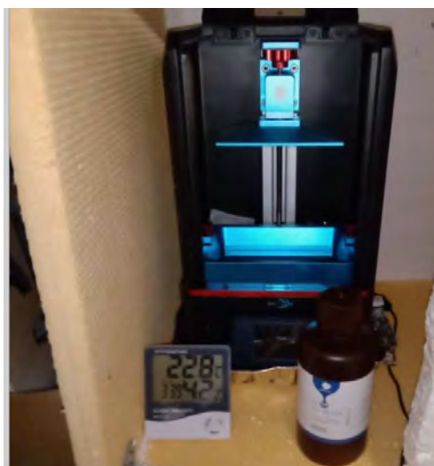
Fig.2.4.2. Imprimantă, cameră termică, aparat măsurare condiții termice și rășina utilizată
