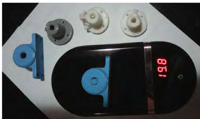
Fig.4.2.1.19. Balanță de farmacie pentru măsurarea reperelor filetate
