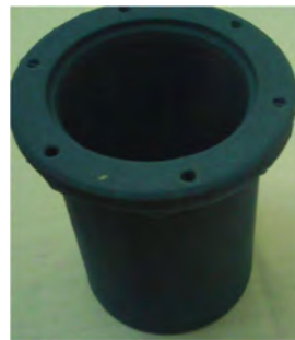
Fig.1.3.12. Corpul unui cilindru pentru o instalație hidraulică sau pneumatică tipărit 3D
