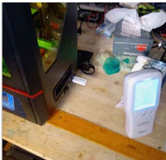
Fig.2.6.4. Sistem pentru determinarea emisiilor în procesul tipărit 3d
