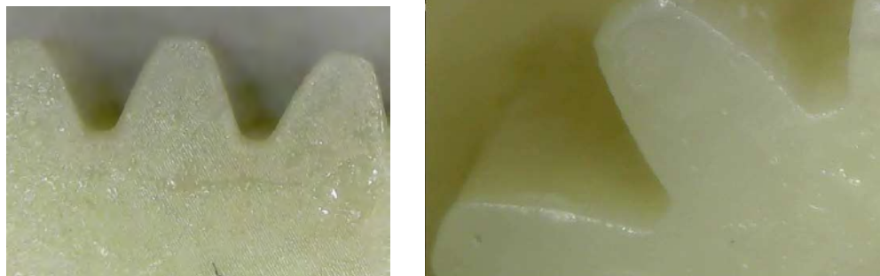
Fig.4.1.2.16. Dantură roată dințată dispusă orizontal imprimată dinte mic la stânga și dinte mare la dreapta
