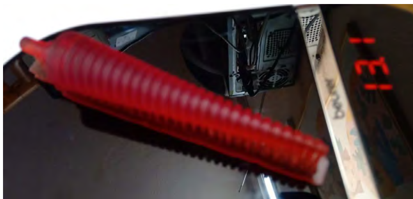
Fig.4.2.2.35. Spirală conică tipărită 3D cu suporturi
