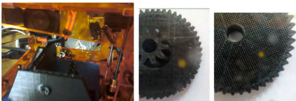
Fig.1.4.3. Fabrikator mini în procesul de imprimare la stânga și structura interioară a roții la dreapta
