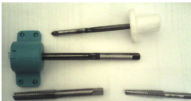
Fig.4.2.1.18. Instrumente pentru calibrarea interioară a găurii șurubului
