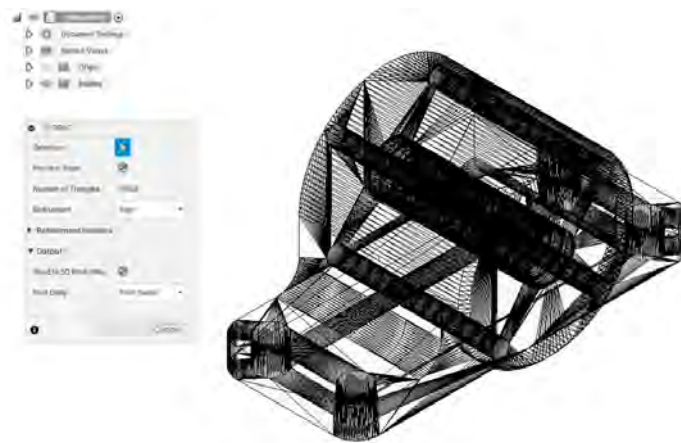
Fig.4.2.2.9. Structura mesh pentru filetul realizat la interiorul unei buçe
