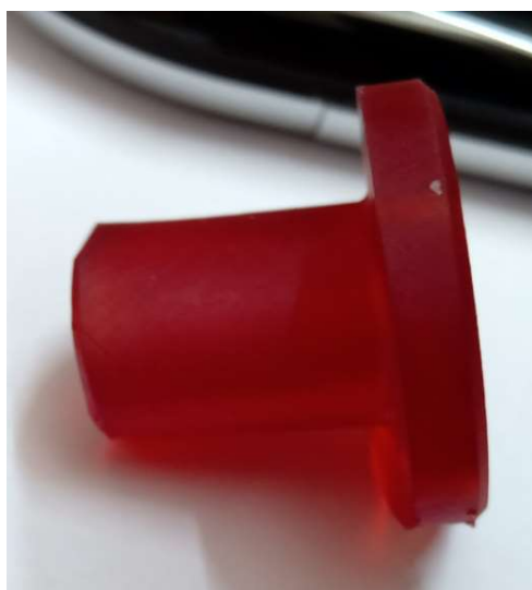
Fig.4.2.2.24. Poziția imprimată orizontală pentru componenta filetată
