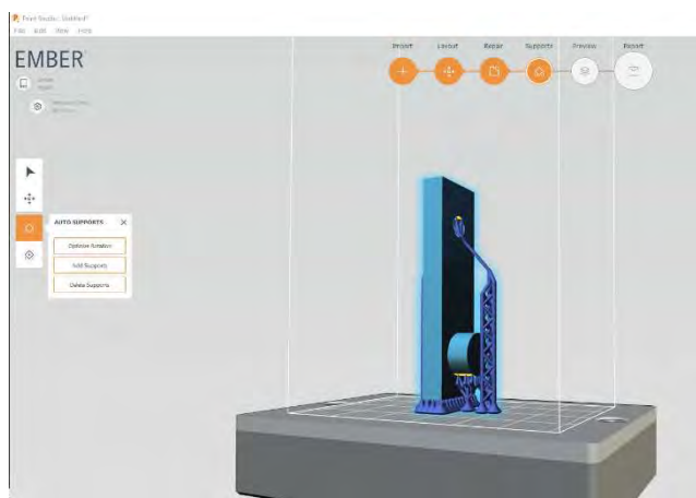
Fig.1.4.7. Poziția și suporturile pentru proba generată pentru imprimanta Ember cu programul Photo Studio
