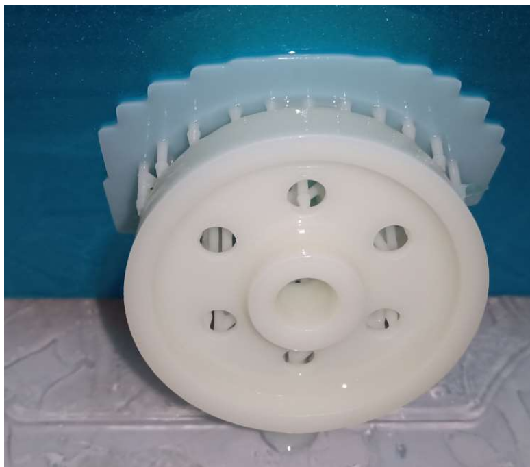
Fig.4.1.2.17. Roată fără dantură imprimată la 30 grade după extragerea din imprimantă
