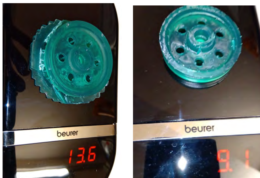
Fig.4.1.2.13. Roată fără dantură orientată orizontal cu suporți în stânga și fără suporți dreapta
