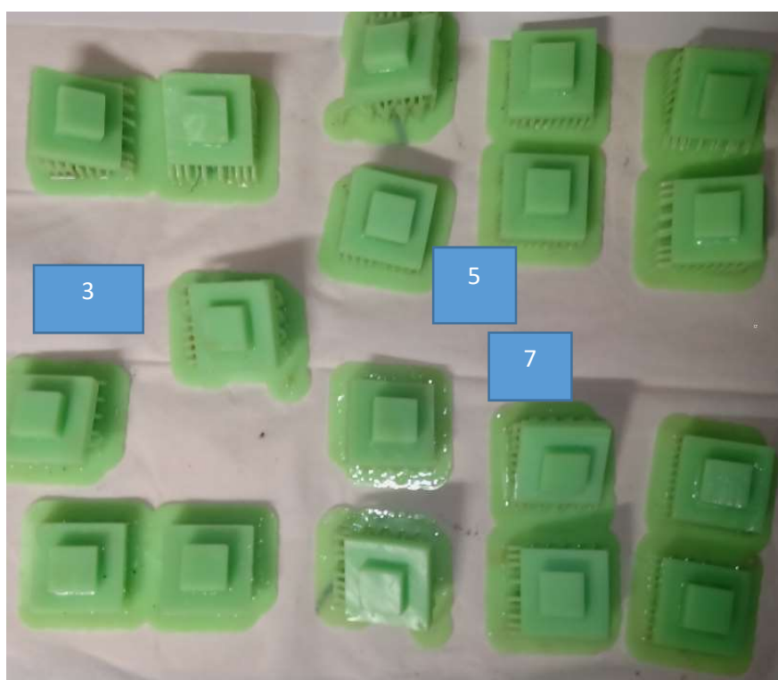
Fig.2.4.4. Element imprimate la diferite grosimi pentru studierea comportamentului dimensional
