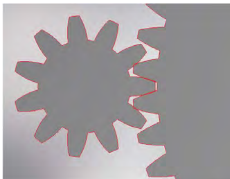
Fig.4.1.1.2. Geometrie dantură roată dințată imprimată 3D
