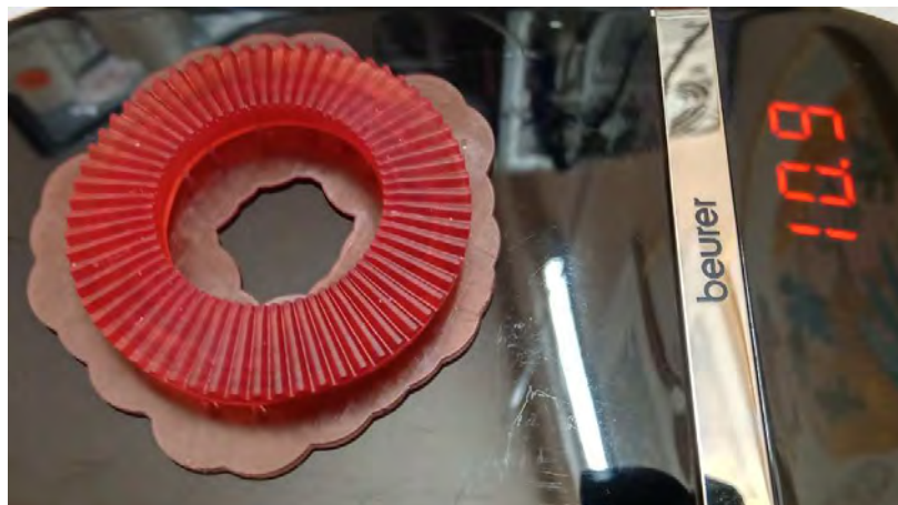
Fig.4.2.2.29. Spirală plan tipărit 3D cu suporturi
