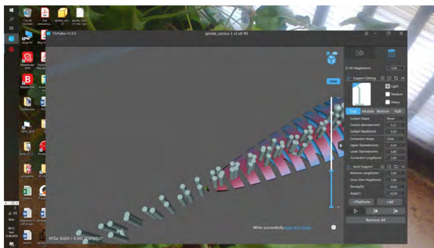
Fig.4.2.2.14. Poziția suportului pentru imprimarea DLP zonele de culoare roșie pentru susținere
