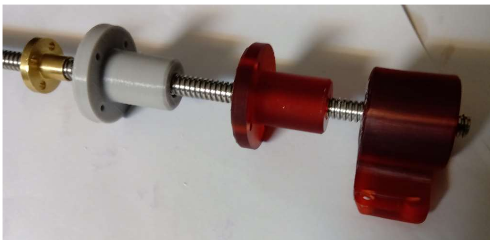
Fig.4.2.2.28. Componente tipărite pentru elementul interior filetat
