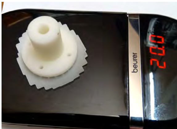
Fig.4.2.2.19. Poziția tipărită verticală pentru componenta filetată
