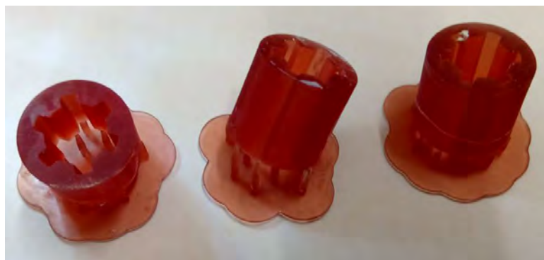
Fig.4.2.2.16. Poziția de imprimare a canalului interior vertical
