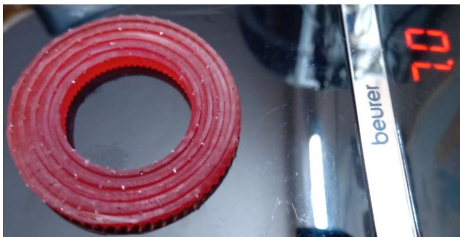
Fig.4.2.2.34. Spirală plan tipărit 3D cu fundă spiralată
