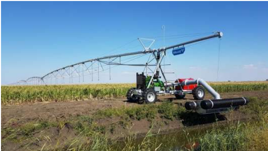
Figura 67 Instalație de irigație prin aspersiune cu deplasare liniară
