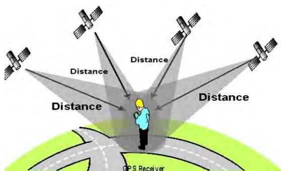
Fig. 2.49 Principiul de achiziționare a datelor GNSS
