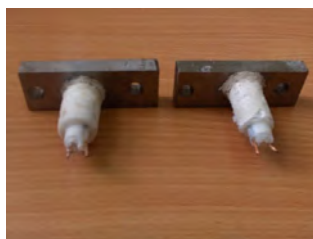
Fig.6.15a Probe experimentale în care au fost montate termocuple în vedere determinărilor experimentale
