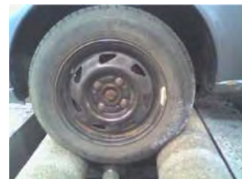
Fig.7.26 Poziționarea roților punții față pe rolele instalației de testare
