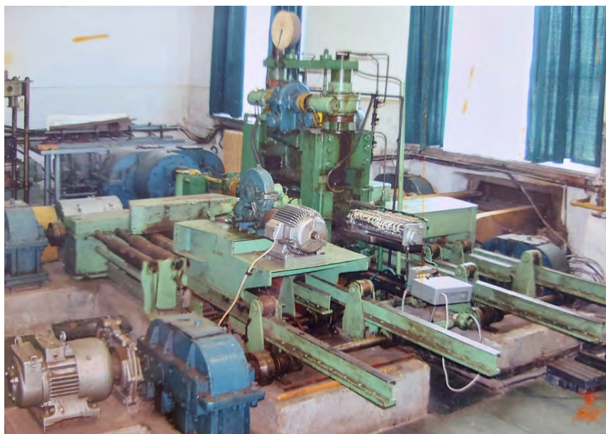
Fig.3.1 Ansamblul general al laminorului degrositor experimental, destinat studiului regimului termic al cilindrilor de laminare la cald
