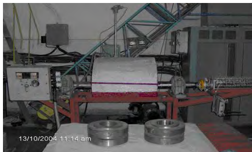
Fig.5.1 Ansamblul instalației pentru determinarea rezistenței la oboseală termică a cilindrilor de laminare la cald
