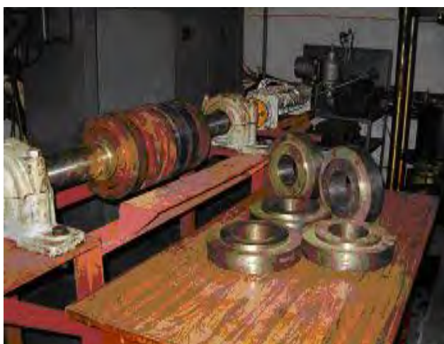
Fig.5.7 Ansamblul a două loturi de probe, unul montat pe axul principal și unul în așteptare
