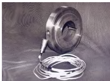
Fig.5.5 Termocuplu asamblat și pregătit pentru instalare în inelul experimental
