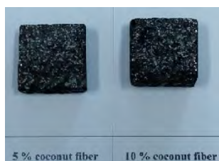
Fig.7.2 Epruvete pentru determinarea caracteristicilor fizico-mecanice
