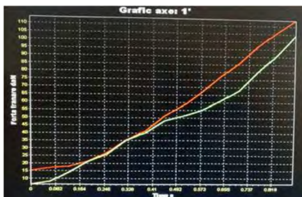
Fig.7.27 Graficul de variație a forței de frânare pentru puntea față în varianta 1
