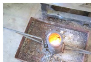
Fig.7.5 Formă cilindrică în care s-a evacuat șarja elaborată
