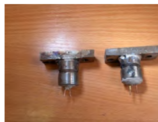
Fig.6.15b Ansamblul probe-termocuple-piese de protecție montate în vederea montării în instalația experimentală
