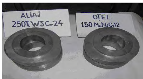
Fig.5.14 Probele inele confecționate pentru încercări de durabilitate la oboseală termică a oțelului 150MoNiCr12 și a aliajului 250Ti W3Cr24
