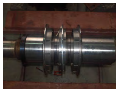
Fig.6.7 Discurile suport laterale și intermediare, pregătite în vederea montării probelor
