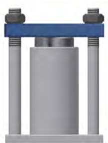
Fig. 7.7 Model pentru matrița de realizare a pinilor din material compozit , [58]
