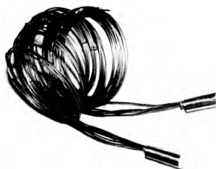
Fig.3.11 Ansamblul tensiometrului pregătit pentru montaj în caja de lucru a laminorului
