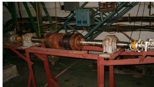
Fig.5.1 Ansamblul instalației pentru determinarea rezistenței la oboseală termică a cilindrilor de laminare la cald
