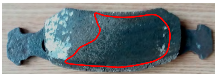
Fig.7.21 Suprafața de contact a plăcuței de frână după efectuarea frânărilor succesive
