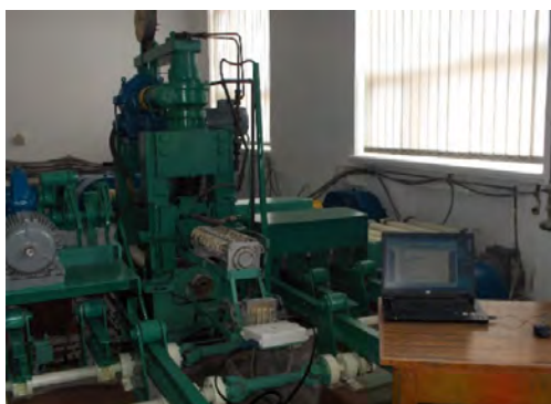
Fig.3.7 Ansamblul laminorului experimental echipat cu module analogice
