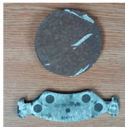
Fig.7.19 Suportul metalic și proba din material compozit
