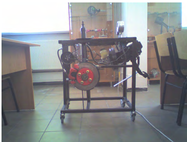
Fig.7.17 Ansamblul general al instalației experimentale pentru testarea materialelor de fricțiune la frânări intensive
