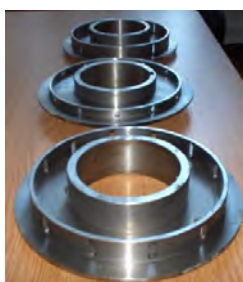
Fig.6.6 Discurile laterale și cel intermediar pregătite în vederea montării în instalația experimentală
