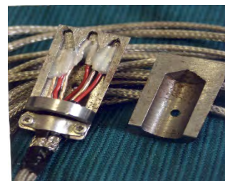
Fig. 5.6 Secțiune longitudinală printr-un termocuplu
