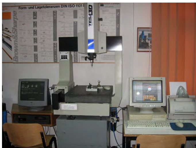
Figura 2.2.24. Mașina TESA MicroMS 343 cu antrenare manuală
