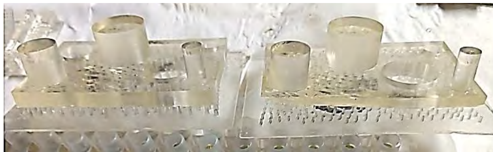
Figura 2.3.78. Piese transparente printate cu un timp de 8 s: structură grea în stânga și structură medie în dreapta.
