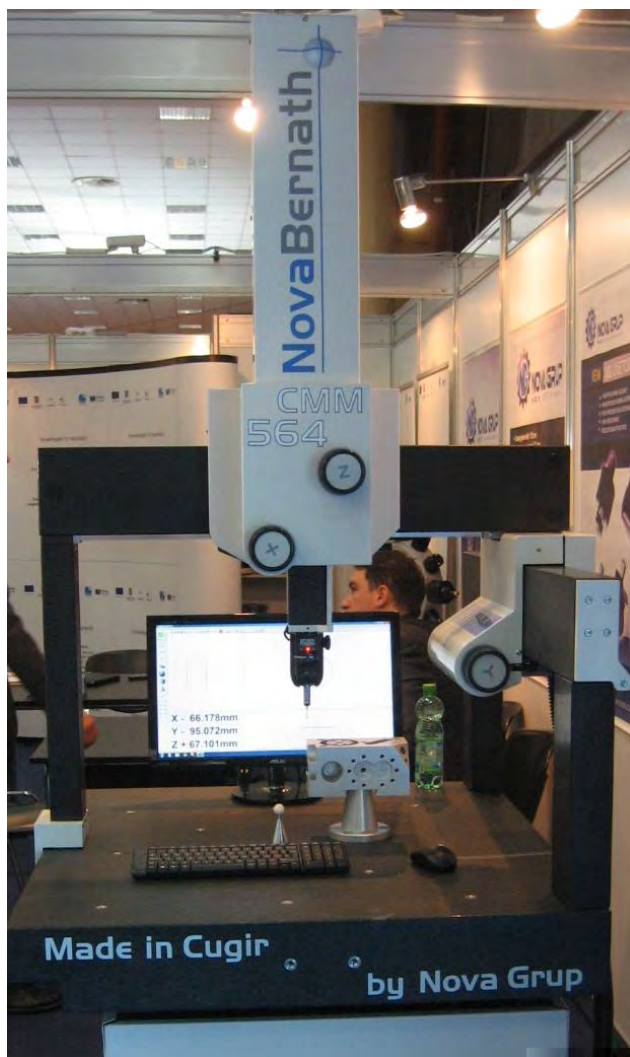
Figura 2.2.40. Prototipul mașinii CMM 564 cu punte în ”L”
