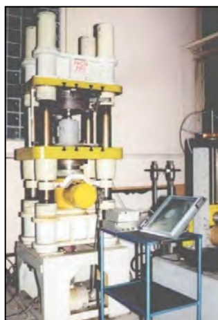
1 - presa PACH 200; 2 – traductor de forță; 3 - element de sprijin; 4 - bilă (sau dorn); 5 - epruvetă; 6 - placă de sprijin; 7 – aparat de măsurat forță; 8 - presă RM; 9 - piesă de sprijin
