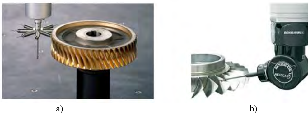
Figura 2.2.20. Măsurare cu diferite sisteme de palpate: a) sistem de palpate cu palpatoare în stea; b) cap de măsurare motorizat, rotativ.
