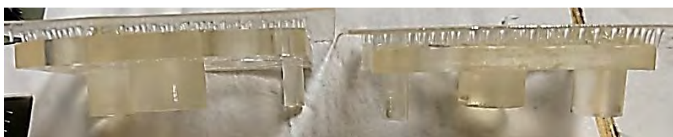
Figura 2.3.79. Piese transparente printate cu 10 s pentru structura grea în poziția din stânga și cu 8 s pentru structura medie în poziția din dreapta.
