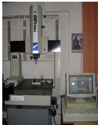
Figura 2.2.41. Descriere mașină TESA-manuală:
