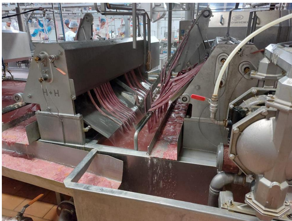
Fig.1.1 c Linie automată de prelucrare a intestinelor subțiri, arhivă personală foto
