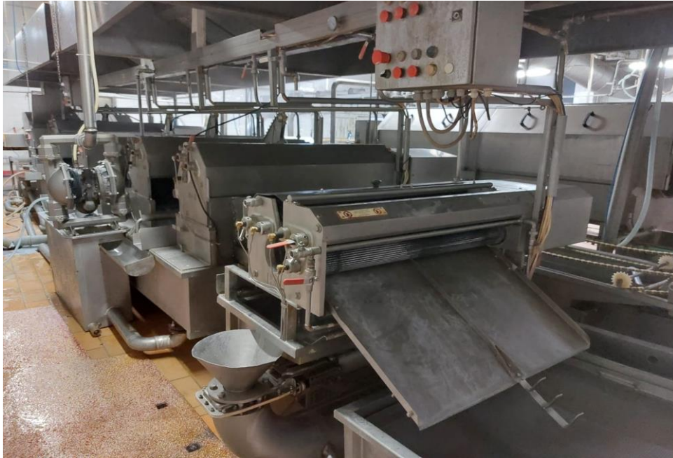
Fig.1.1 a Linie automată de prelucrare a intestinelor subțiri, arhivă personală foto
