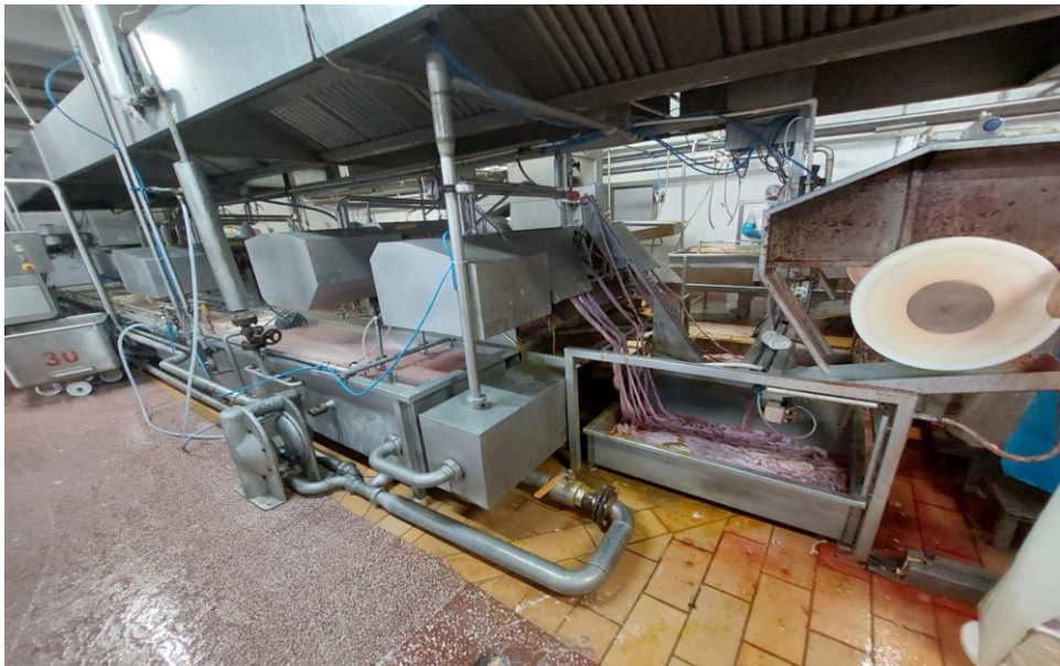
Fig.1.1 b Linie automată de prelucrare a intestinelor subțiri, arhivă personală foto
