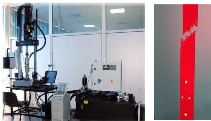
Fig.5.5. Efectuarea testelor de tracțiune monoaxială (mașina pentru încercări statice și dinamice Instron 8874)
