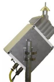
Fig. 6.4.10. Ice Detector Module
