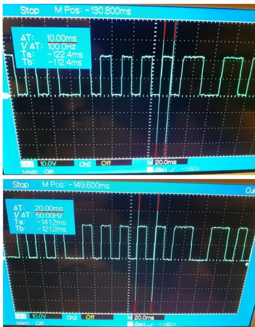
Figura 20. Semnalul digital generat pe baza mesajelor specifice livrate de Aplicația Gateway la o recurență de 10 ms
