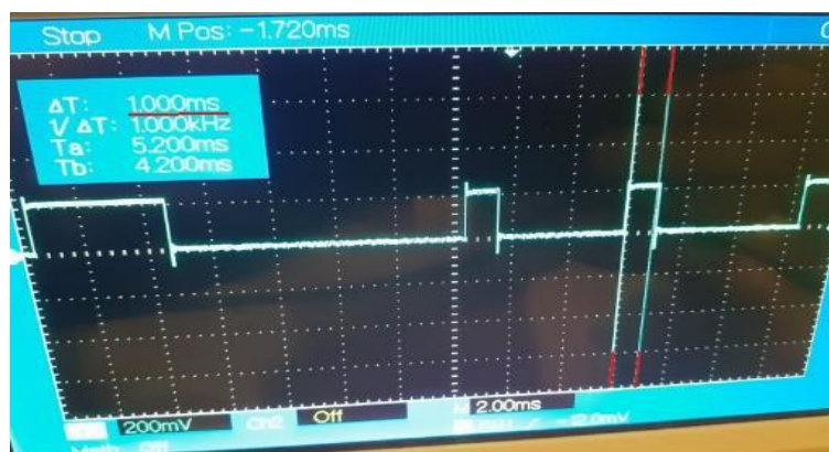
Figura 23. Semnalul digital generat pe baza mesajelor specifice livrate de Aplicația Gateway la o recurență de 1 ms
