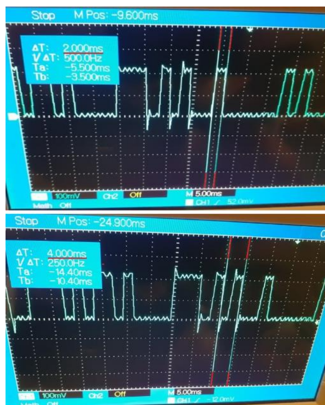
Figura 22. Semnalul digital generat pe baza mesajelor specifice livrate de Aplicația Gateway la o recurență de 2 ms
