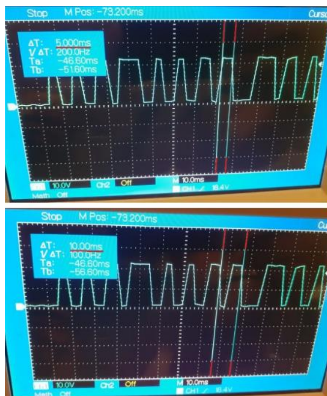
Figura 21. Semnalul digital generat pe baza mesajelor specifice livrate de Aplicația Gateway la o recurență de 5 ms
