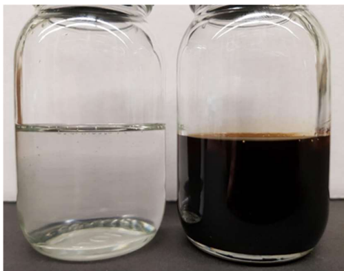
Figura 1. Produsul de glicoliză obținut din deșeuri de spumă PU flexibilă și dietilenglicol la un raport 1:1 (g/g), în autoclavă (imaginea din dreapta), comparativ cu poliolul virgin (imaginea din stânga)
