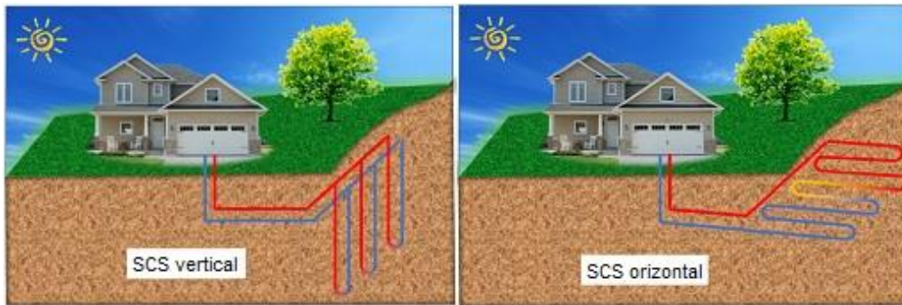
Fig. 3.4 Configurarea SCS vertical și orizontal
