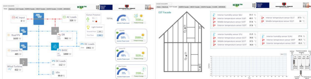
Interfața de monitorizare SCADA
