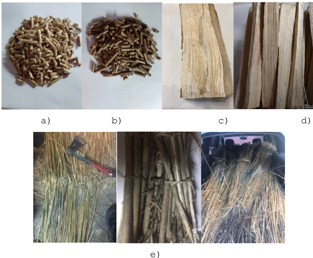
Figura 5.2. Materiale alese pentru procesul de ardere: a)peleți rășinoase, b)peleți fag cu brad, c)carpen, d)rășinoase, e)câneță
