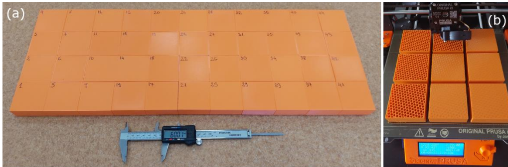
Fig. 7. Epruvetele printate 3D utilizate pentru testele de impact: imagine de ansamblu (a) și procesul de fabricație (b)
