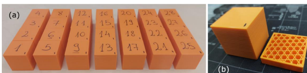
Fig. 9. Epruvetele printate 3D pentru testele de oboseală: imagine de ansamblu (a) și structura internă (b)
