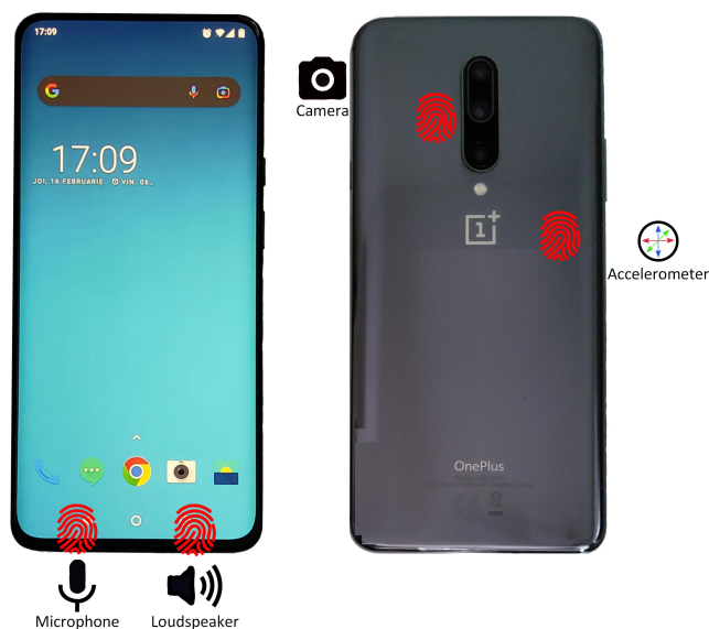
Fig. 1. Un smartphone generic cu senzorii și traductoarele folosite la amprentare
