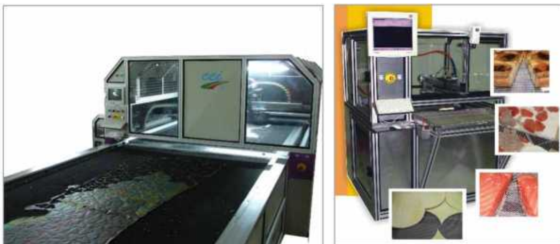
Figură II.57. Sisteme cu jet bazate pe tehnologia de tăiere a apei curate (CEI, 2020)
