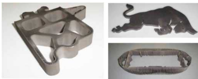
Figură II.58. Piese metalice realizate prin tăiere cu jet de apă abraziv bazate pe tehnologia CEI Group (CEI, 2020)
