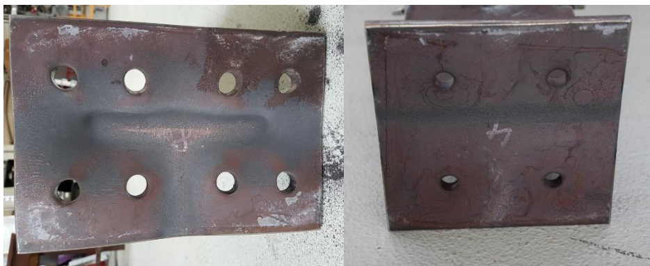
Fig. 4-6 Rezultatul deformării specițiilor
