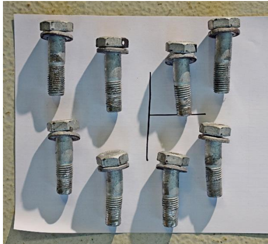
Fig. 4-4 Degradarea șuruburilor testate în cazul specimenului 4B_I360_t12_M16_P3
