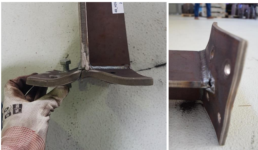
Fig. 5-10 Forma deformată a plăcii de capăt pentru profilul HEA260 (stânga) și IPE360 (dreapta)
