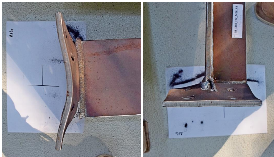
Fig. 4-5 Deformația plăcii de capăt și cedarea sudurii în cazul specimenului 4B_I360_t12_M16_P3
