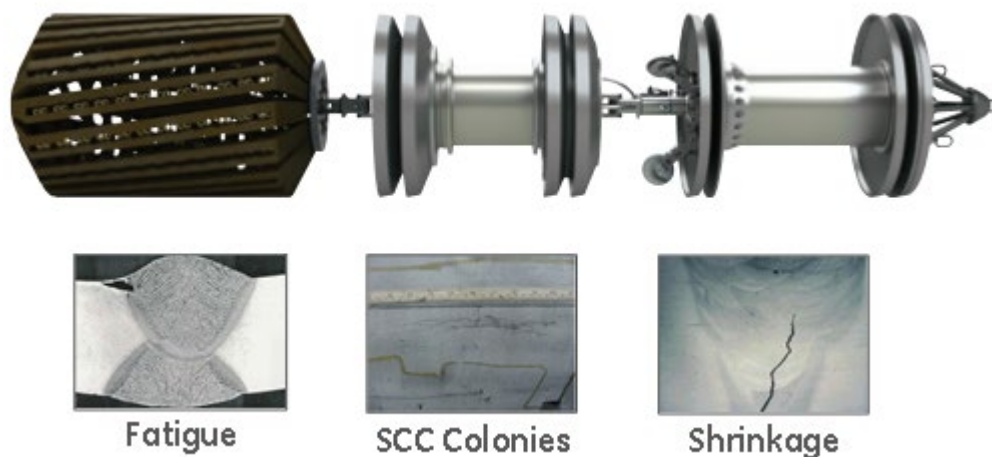
Figura 1. UltraScan CDP [2] și diferite tipuri de fisuri [11]
