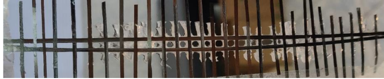
Fig. 21: Benzi împletite folosite ca armătură în matricea de silicon
