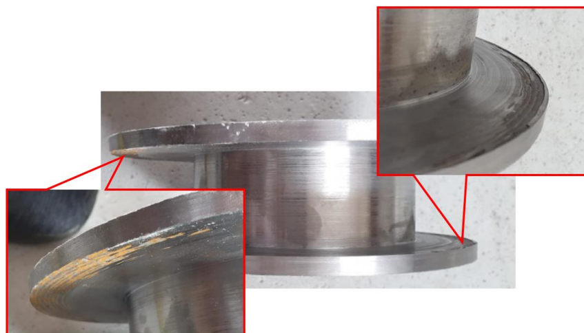
Figura 42. Efectele fixării incorecte a țevii în poziționator
