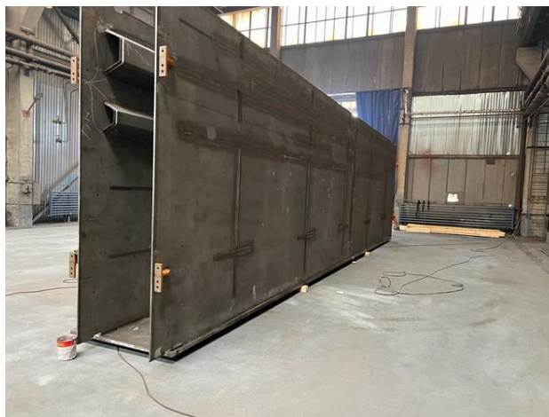
Fig. 71. Imagine cu inima îndreptată
