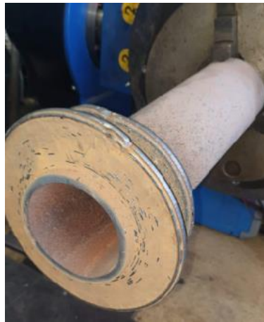
Fig. 46. Piesa obținută strat cu strat
