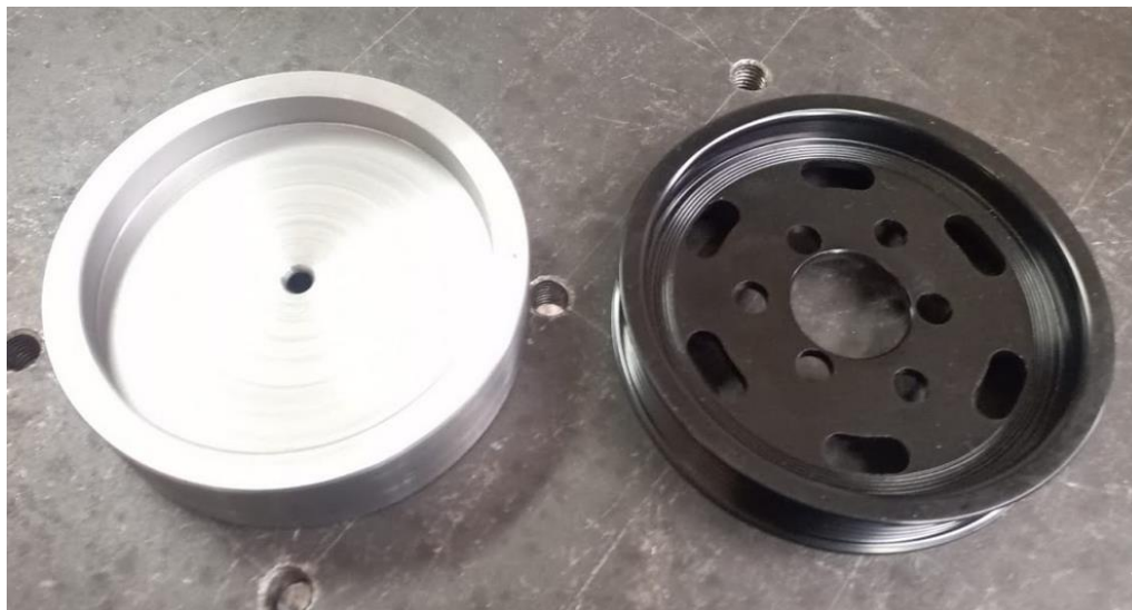
Figura 38. Reper finalizat și fulie originală
