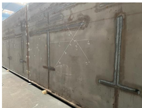
Figura 70. Zonele în care a fost încălzită inima
