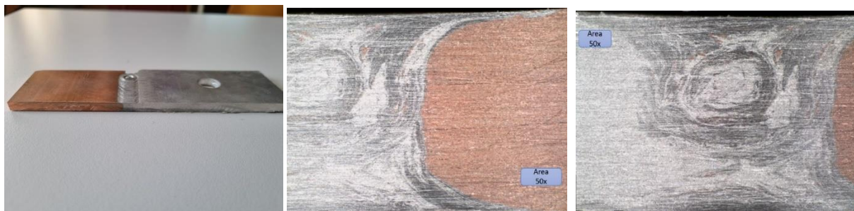
Figura 66. Îmbinarea disimilară AL-Cu și analiză metalografică în cazul îmbinării [29]
