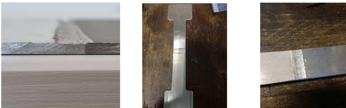
Figura 61. Îmbinare disimilară AlMg3 cu oțel inoxidabil X2CrNiMo17-12-2
