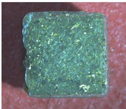
Figura 18. Imagine macroscopică cu distribuția particulelor și benzilor scurte în proba printată 3D
