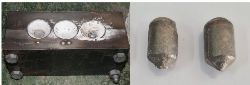
Figura 10 Forma de turnare a aliajului primar și aliajul primar solidificat
