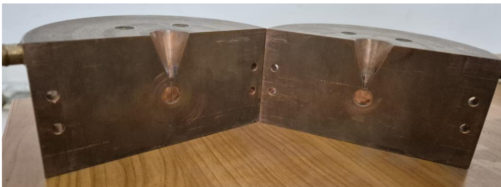
Figura 12. Matrița din cupru pentru obținerea aliajelor amorfe masive sub formă de discuri
