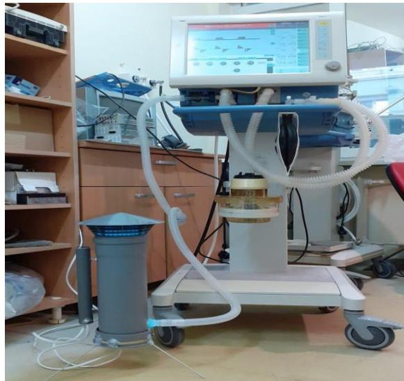
Funcționarea dispozitivului se bazează pe reducerea încărcăturii microbiologice prin expunerea la radiații ultraviolete de tip UVC a aerului expirat de pacienții aflați în stare critică, infectați cu SARS-CoV-2, care sunt intubați și ventilați mecanic. Dispozitivul este conectat la portul de exhaustare al ventilatorului care actualmente comunică liber cu atmosfera.
