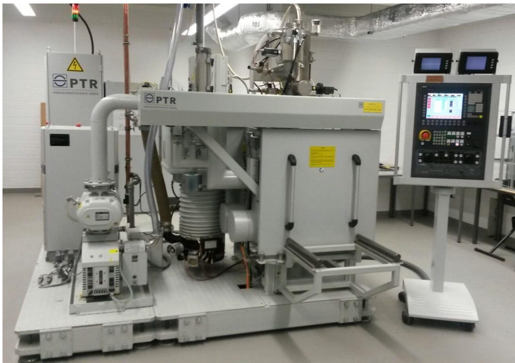
Fig. 7 Instalatia de tratament cu fascicul de electroni din dotarea Universității de Științe Aplicate Gelsenkirchen Germania
