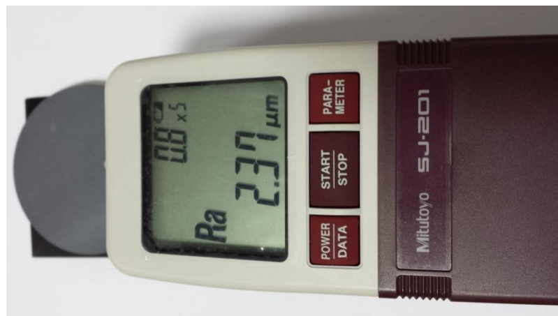
Fig. 20 Imagine din timpul masurarii rugozitatii Ra
