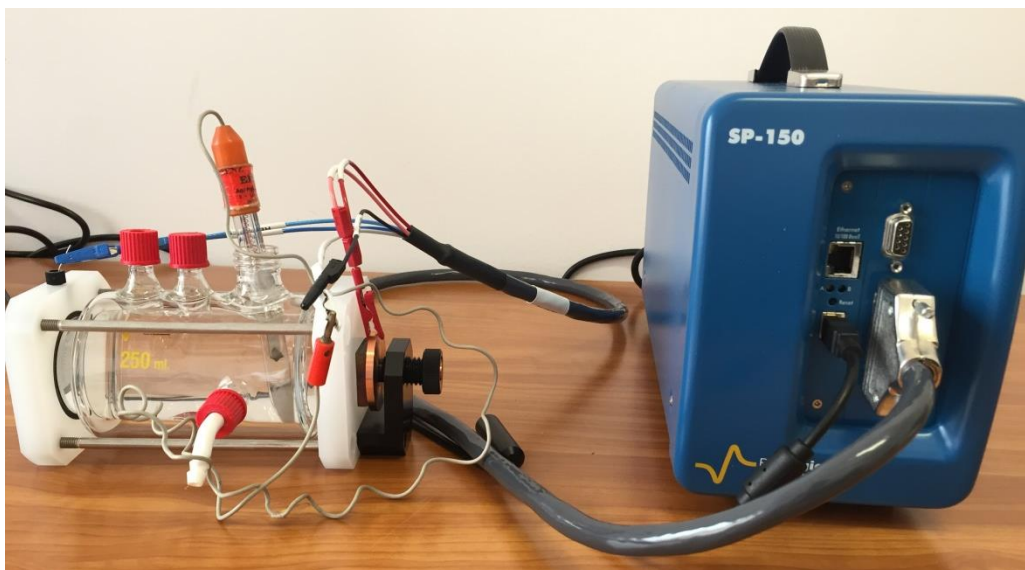
Fig. 28 Instalația de voltametrică ciclică SP150
