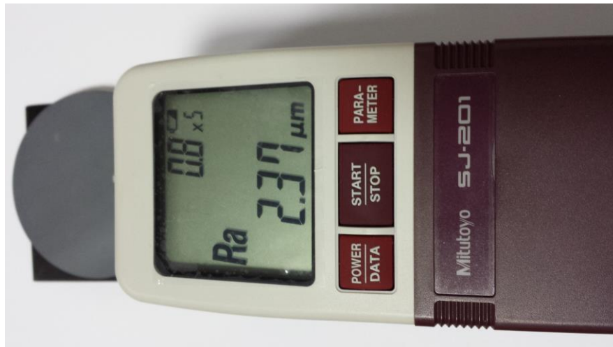
Fig. 20 Imagine din timpul masurarii rugozitatii Ra
