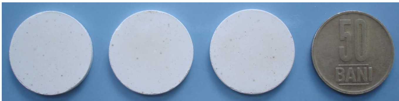
Fig. 4.10. Pelete de YAlO_3 sinterizate la 1500 °C timp de 4 ore.
