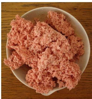
Fig. 4.11. Pulbere de YAl_{0.95}Cr_{0.05}O_3 obținută prin metoda combustiei (cu amestec de combustibili), fără calcinare suplimentară.
