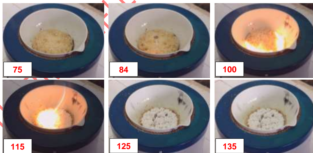
Fig. 3. Imagini în diferite momente (secunde) din timpul desfășurării reacției de combustie (2).
