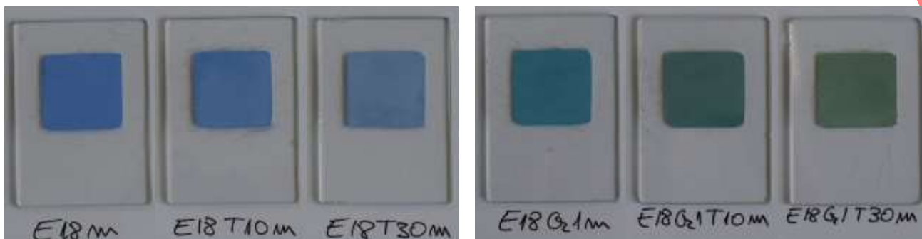
Fig. 7. Pigmenții albaştrii (E18-T10m și E18-T30m) și albaştrii-verzui cu adaos de \text{TiO}_2 (E18-Cr1-T10m și E18-Cr1-T30m) obținuți prin metoda combustiei.
