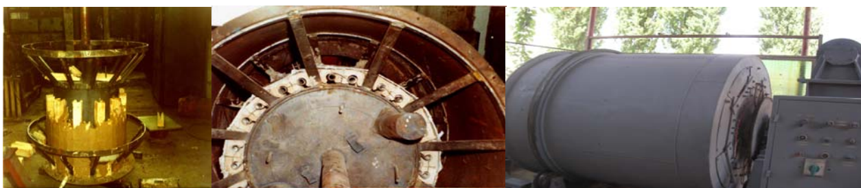
Figura 3.40. Instalația experimentală - cuptor tubular rotativ [71]
