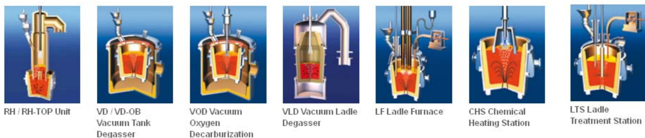
Figura 2.17. Tehnologii de tratament secundar al oțelului [24]
