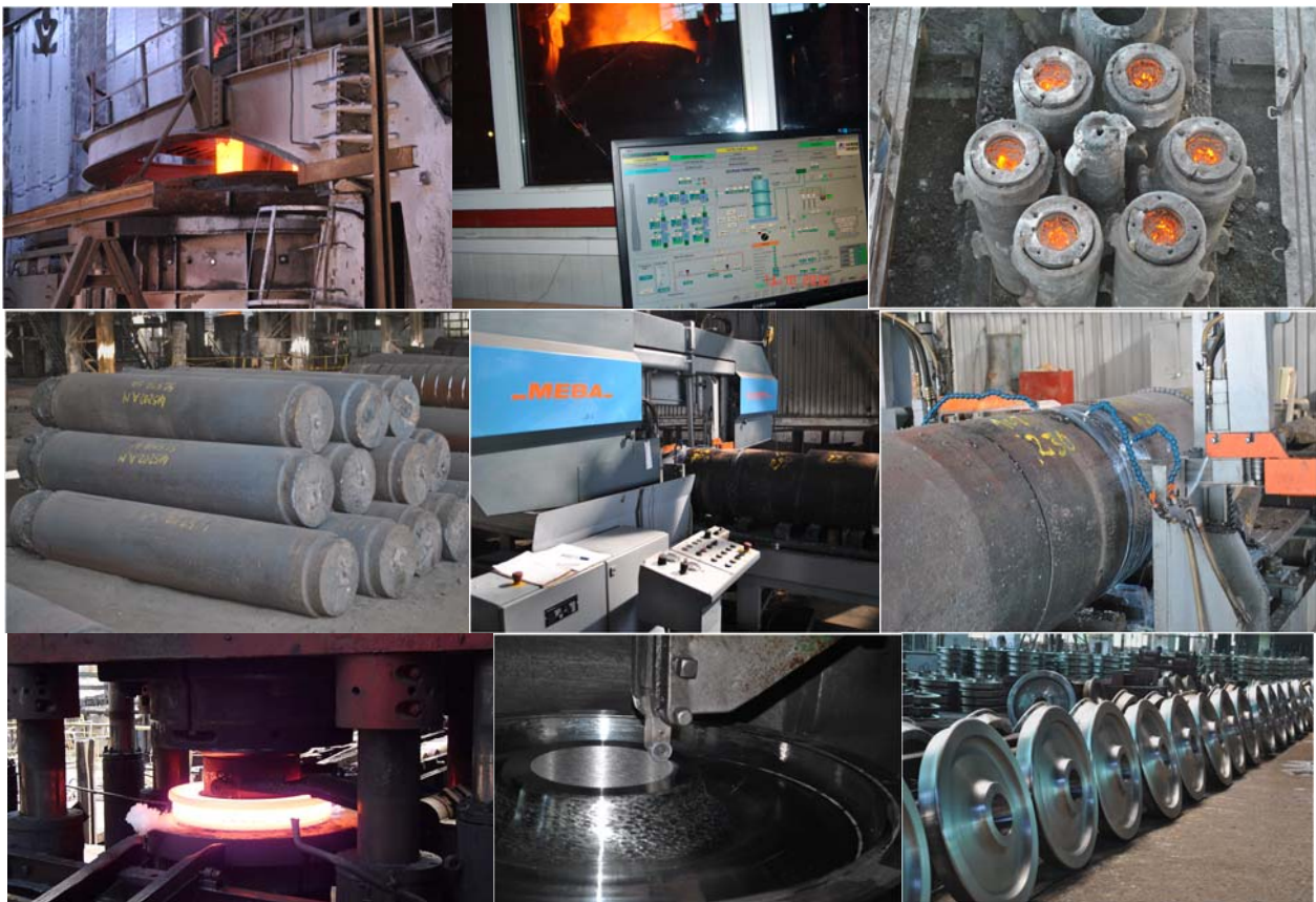
Figura 2.78. Fluxul tehnologic de fabricație a roților la SC SMR SA Balș [41]
