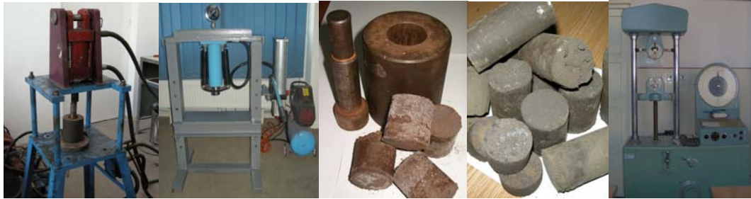
Figura 3.20. Aspecte din timpul procesării deșeurilor prin brichetare [71]
