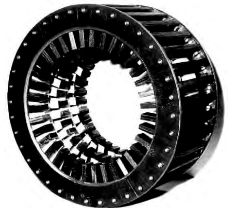
Figura 3.4.1.23 Ansamblul stator înainte de introducerea înfășurării indusului.
