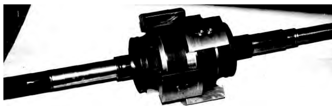
Figura 3.4.1.24 Ansamblul rotor fără colivie de amortizare pentru modelul experimental.
