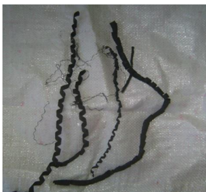
Fig. 11. – Umplutură de șpan de oțel pentru filtrul de H 2 S
