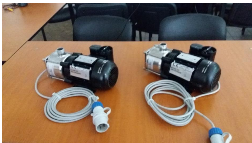
Fig 14 – Pompe de recirculare
