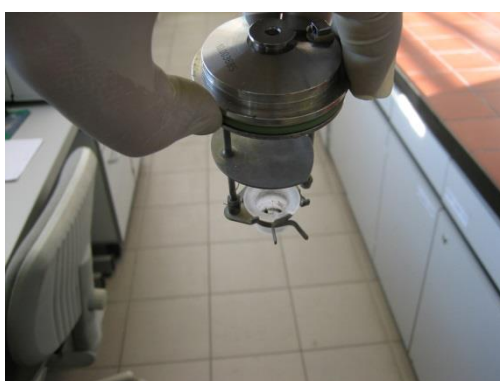
Fig. 39 – Introducerea pastilei de material în bomba calorimetrică
