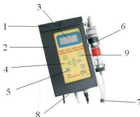
Fig. 26– Componența analizorului Delta 1600 S IV 1 – port conectare imprimantă externă, 2 – acumulator, 3 – afișaj, 4 – sistem de operare prin deplasare cu săgeți în meniul de control, 5 – comutator on – off, 6 – filtru captare picături apă, 7 – conexiune la sonda de prelevare gaz, 8 – conexiune la PC 9 – buton iluminare afișaj
