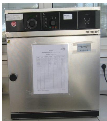
Fig. 33 – Etuva utilizată pentru determinarea umidității mostrelor
