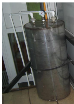
Fig. 6. – Rezervor stocare biogaz [1]
