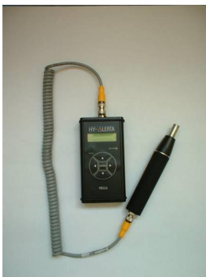
Fig. 24 – Detector cu senzor de hidrogen HY ALERTA H2 SCAN 0-100% H2
