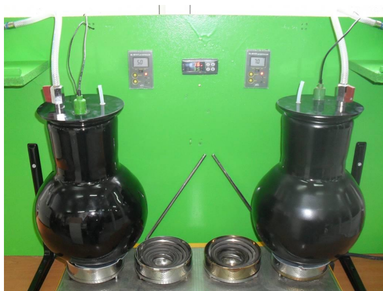
Fig. 31 – Detaliu – testarea părții termice și a celei de pH
