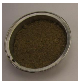
Fig. 34 – Tulpină de porumb după proces fermentație anaerobă, 40 zile (partea stângă) și orez (partea dreaptă) după proces fermentație anaerobă, 40 zile – după determinarea conținutului de umiditate
