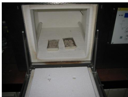
Fig. 45 – Realizarea cenușii la temperatura de 550 °C
