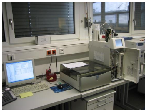
Fig. 42 – Vedere de ansamblu a echipamentului destinat analizei prin cromatografie cu ioni
