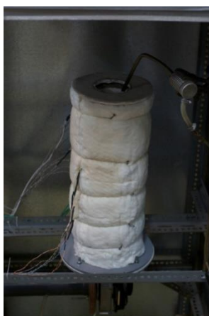
Fig 94 - Vedere frontală a incintei de test pentru arderea catalitică a biogazului
