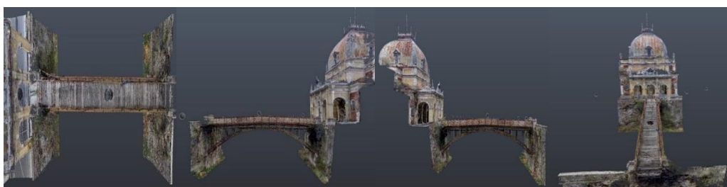
Fig 11. Redarea sub forma unui nor de puncte dens a podului de fier și a intrării principale (Cuzic O.Ș. 2022)
