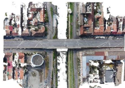
Fig 13. Norul de puncte extras din imaginile captate (Cuzic O.Ș. 2022)
