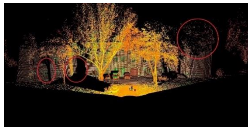
Fig 5. Limitări ale captării TLS în zonele cu vegetație densă (Cuzic O.Ș.2016)
